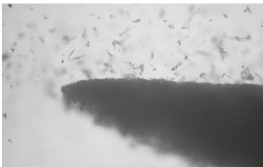
Detailaufnahme: Langsam bilden die Schneekristalle im Windkanal eine Wechte
